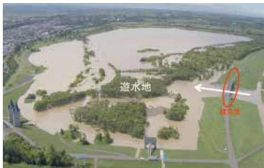
↑平成 28 年 8 月 21 日、初めて石狩川の水が越水し洪水調節を行った砂川遊水地
